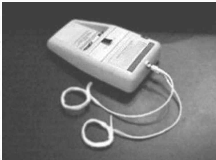
Рис. 17.1. Прибор Риджи-Скан для мониторинга ночных пенильных тумесценций
